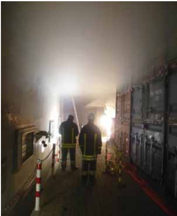
Bild 5-8: Rauchschichtung (hier bei einem Rauchversuch)
