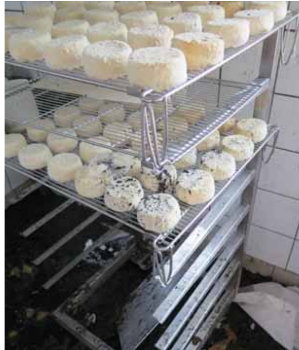
Bild 3-1: Schadenbeispiel Rauchschaaden in der Lebensmittelherstellung; Bei rauchempfindlichen Betriebsarten können bereits kleinere Brandereignisse zu empfindlichen Schäden an Ware und Produktionseinrichtungen führen, was wiederum zu langfristigen Betriebsausfällen führen kann.
