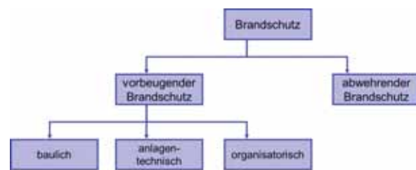
Bild 1: Strukturierung von Brandschutzmaßnahmen
