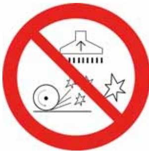
Bild 9: Symbol: Nicht in Verbindung mit funkenerzeugenden Maschinen einsetzen (DIN EN 60335-2-69 Anlage CC)
