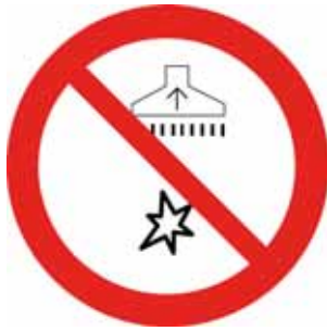
Bild 8: Symbol: Kein glühender Staub oder andere Zündquellen aufnehmen (DIN EN 60335-2-69 Anlage CC)
