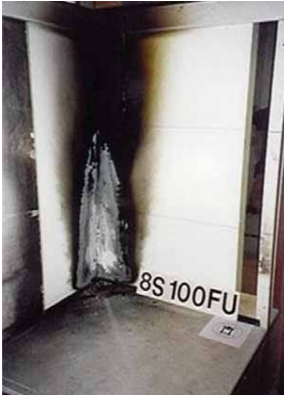
Abb. 6-5: Kernschicht aus PU nach einem SBI-Test
