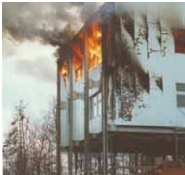
Bild 6.01: Ein Großbrandversuch mit Sandwichelementen als Außenbauteil
