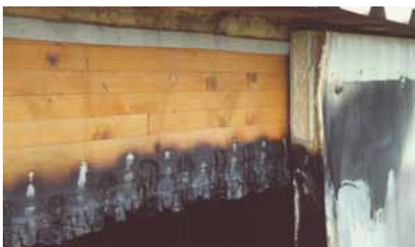
Abb. 7-1: Keine Brandweiterleitung innerhalb der Sandwichelemente
