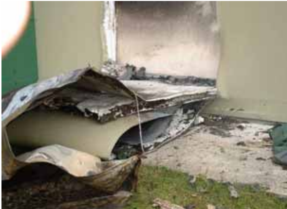
Abb. 6-2: Sandwichelemente nach einem Brand
