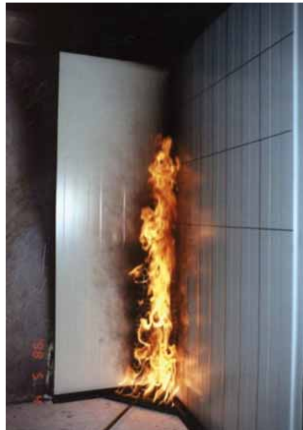
Abb. 6-4: Sandwichelemente beim SBI-Test
