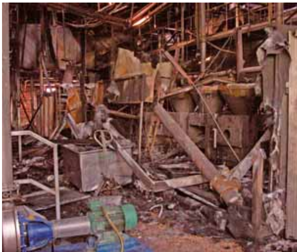
Abb. 13: Eine abgebrannte Räucheranlage.
