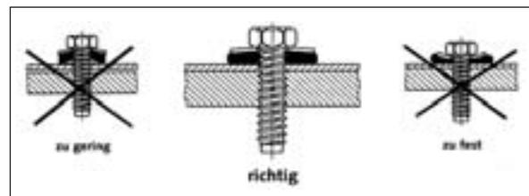
**Bild 4b:** Ausführung von Schraubverbindungen (s.a. IFBS-Montagerichtlinie)
