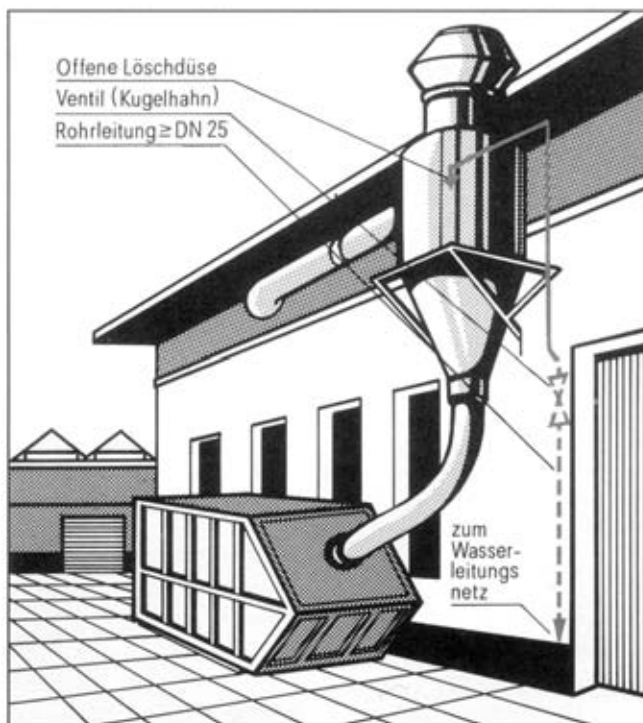
Abb. 2: Müllpreßcontainer mit kontinuierlicher Beschickung
