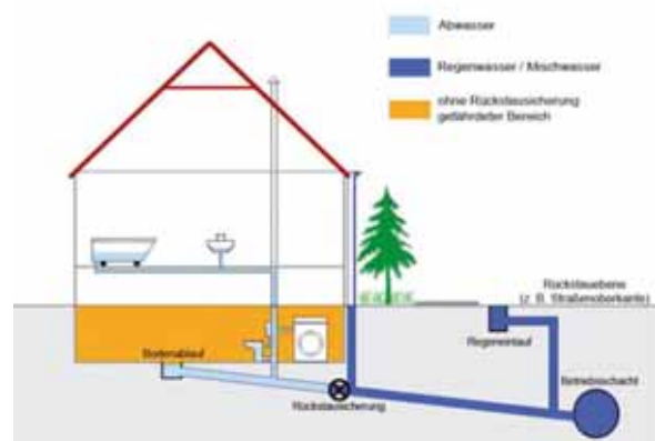
Abb. 6: Anordnung der Rückstausicherung
