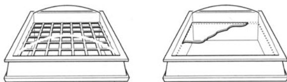
Bild 8-30: Lichtkuppel mit Gitter oder zusätzlicher einbruchhemmender Verglasung
