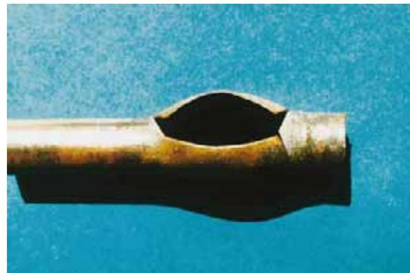
**Abb. 9:** Leitungswasserschäden durch Frost,
