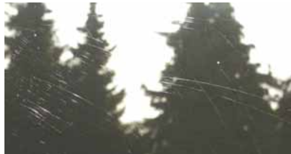
Abb. 14: Beispiel verkratzter Glasscheiben, Quelle: Sachverständigenbüro Dipl. (FH) Eberhard Achenbach, Wardenburg
