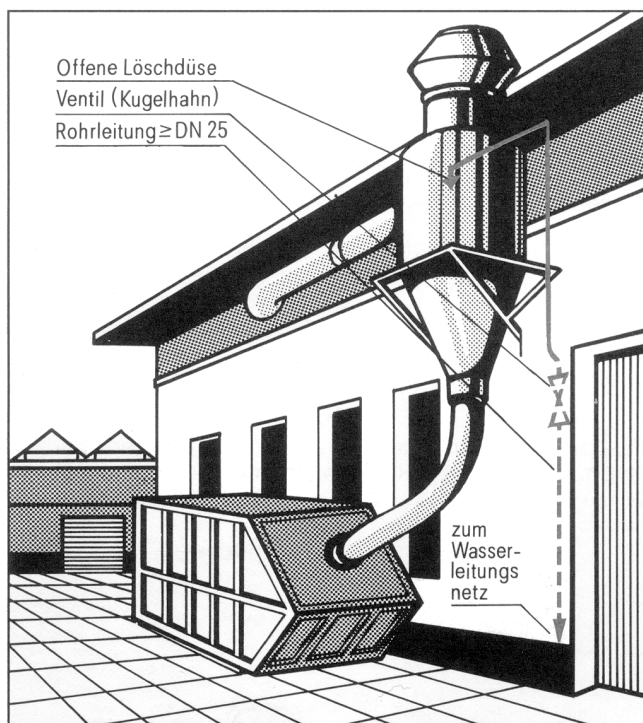
Abb. 2: Müllpreßcontainer mit kontinuierlicher Beschickung
