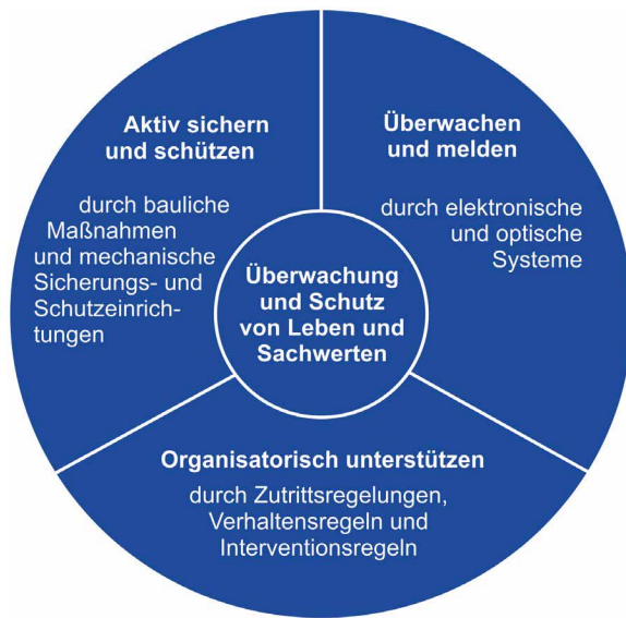
Bild 5-2: Zusammenspiel verschiedener Sicherungsmaßnahmen
