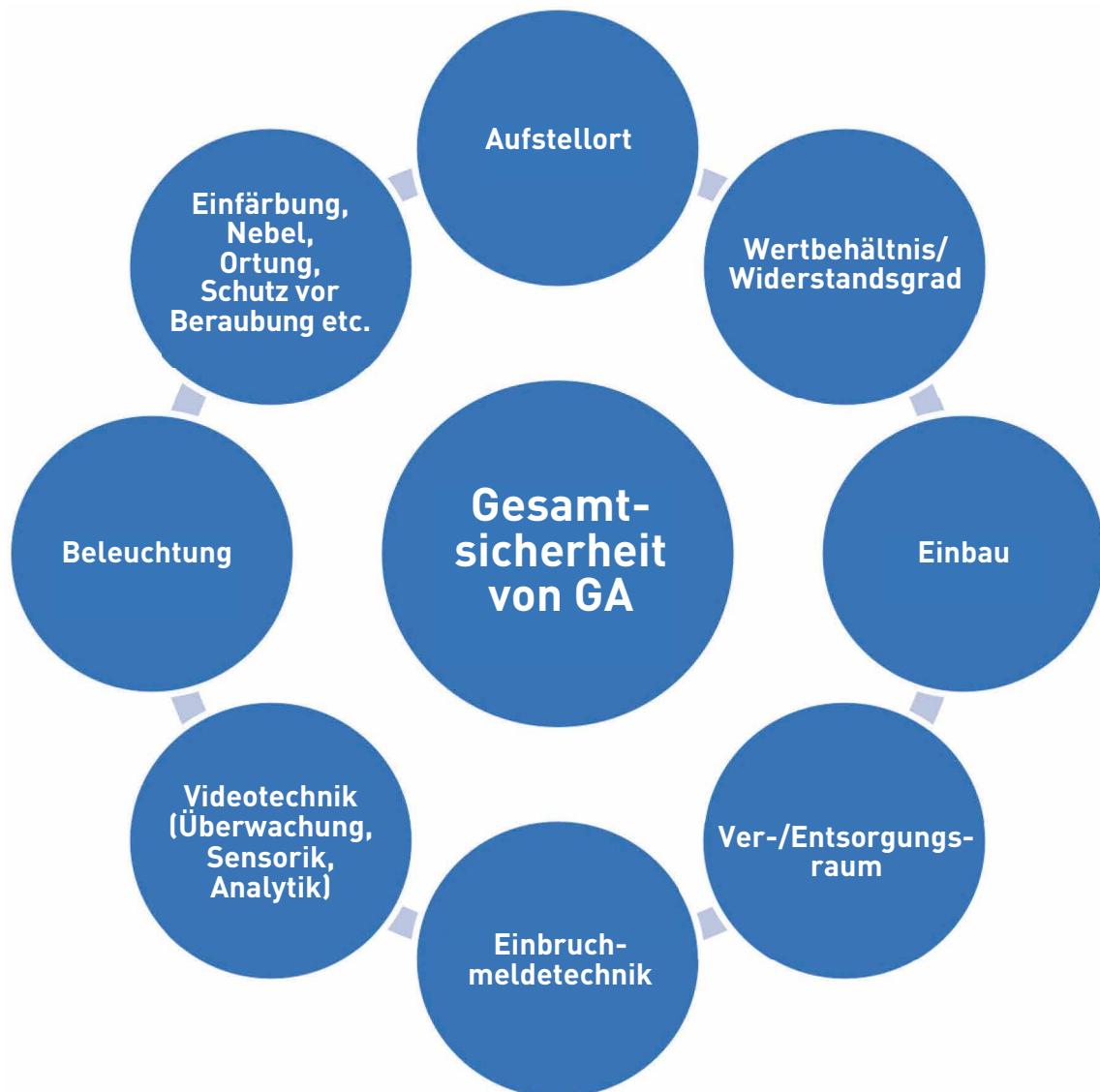
Bild 7-1: Gesamtkonzept Sicherung (ohne Gewichtung der einzelnen Maßnahmen)
