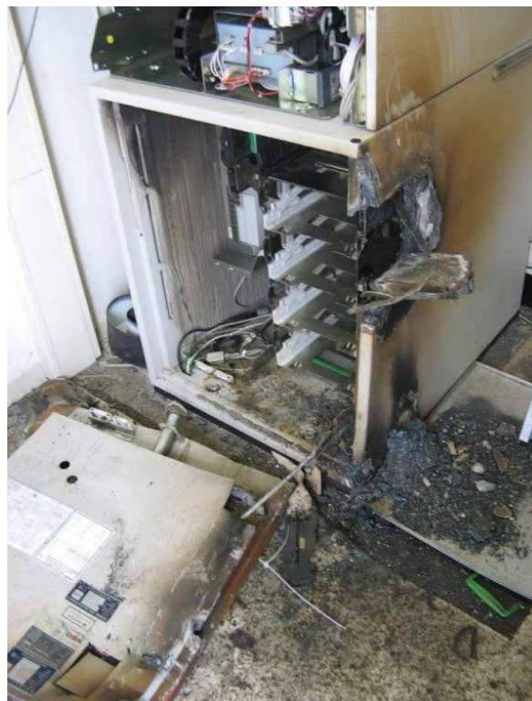
Bild 3-4: Türöffnung nach Brennschneiden
