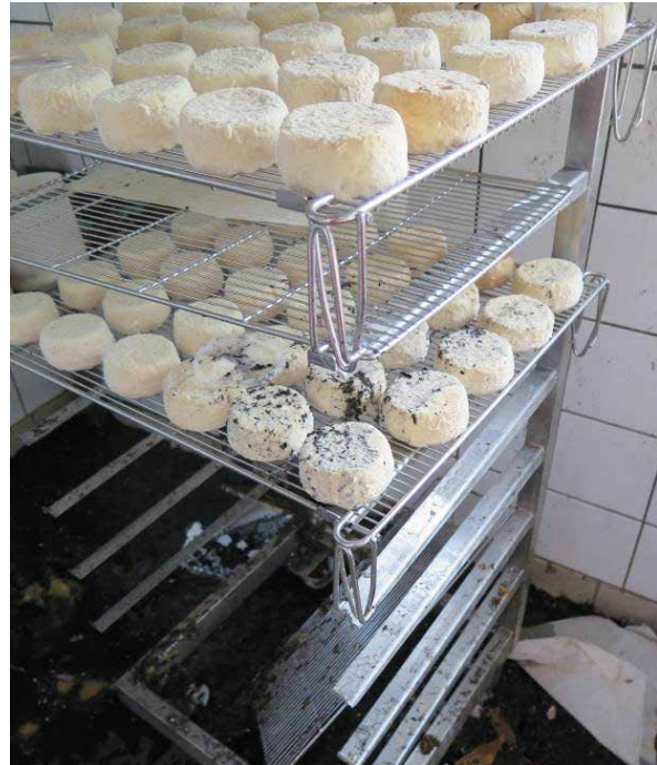
Bild 3-1: Schadenbeispiel Rauchschaden in der Lebensmittelherstellung: Bei rauchempfindlichen Betriebsarten können bereits kleinere Brandereignisse zu empfindlichen Schäden an Ware und Produktionseinrichtungen führen, was wiederum zu langfristigen Betriebsausfällen führen kann.
