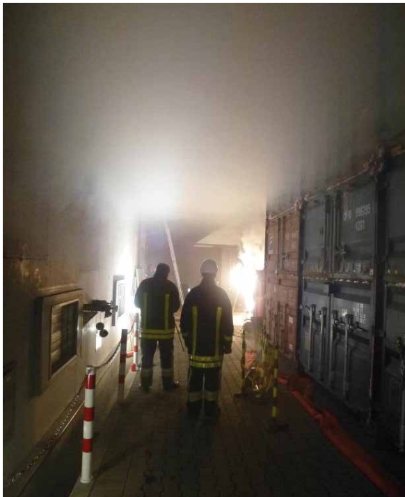
Bild 5-8: Rauchschichtung (hier bei einem Rauchversuch)
