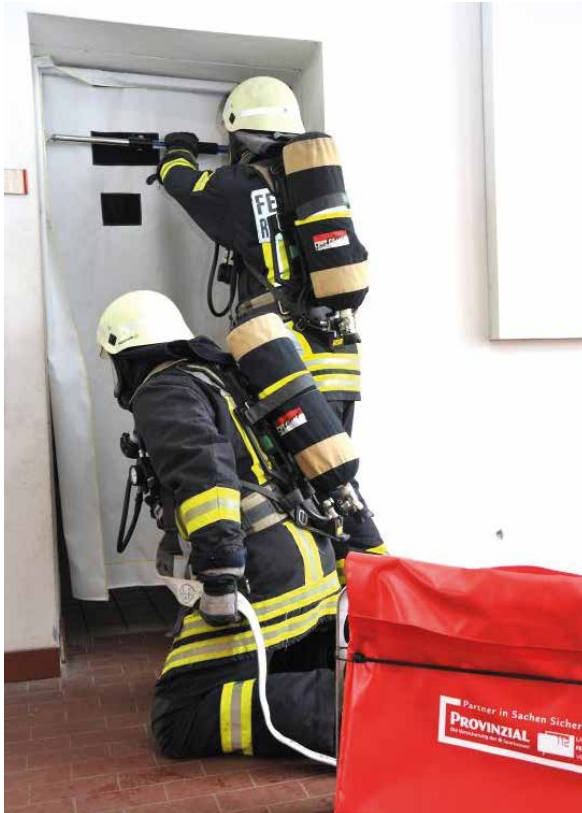
Bild 5-14: Mobiler Rauchverschluss (Quelle: Provinzial Rheinland Versicherung AG, Düsseldorf)
