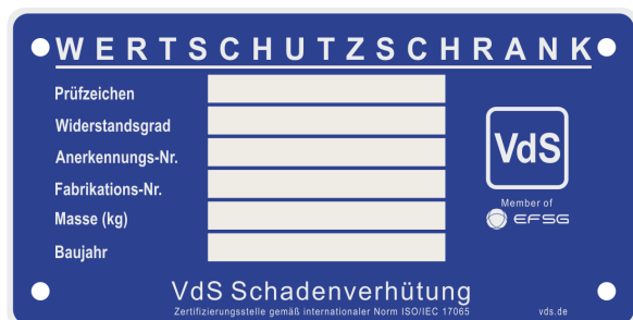
Bild 10-6: Kennzeichnung von Duplexschränken
