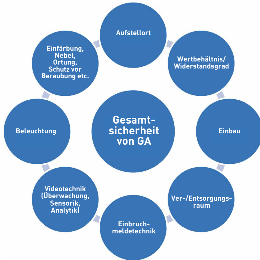
Bild 6-1: Gesamtkonzept Sicherung (ohne Gewichtung der einzelnen Maßnahmen)
