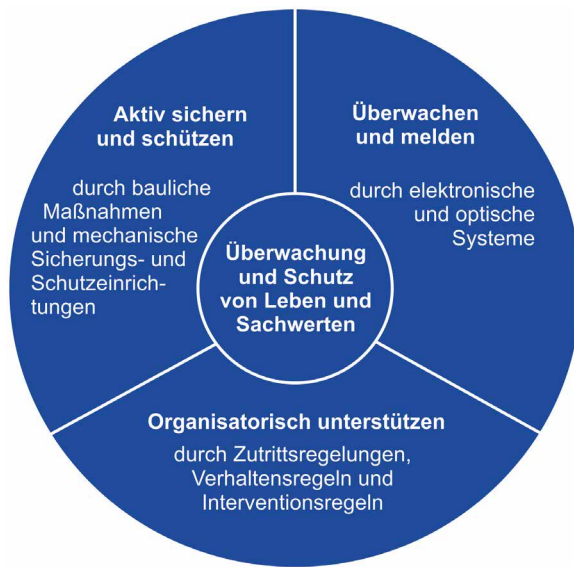
Bild 5-2: Zusammenspiel verschiedener Sicherungsmaßnahmen
