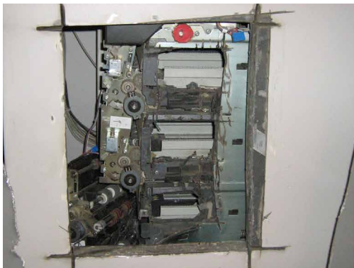
Bild 3-4: Angriff mit dem Winkelschleifer
