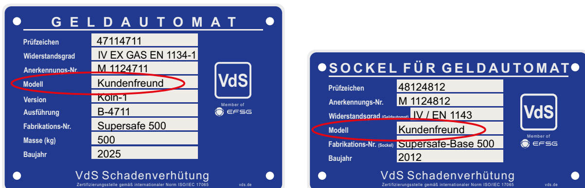
Bild 7-4: Anerkennungsplakette für Geldautomaten-WB und dazugehörigem Sockel
