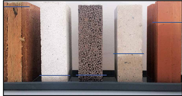
Abb. 3: Wasseraufnahmeverhalten verschiedener mineralischer Wandbaustoffe (© HTW Dresden)
