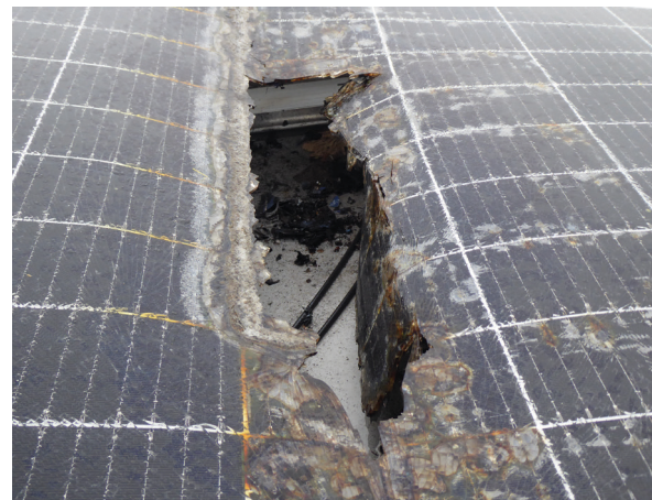
Bild 1: Schaden nach einem im PV-Modul generierten Lichtbogen (Quelle: VGH)
