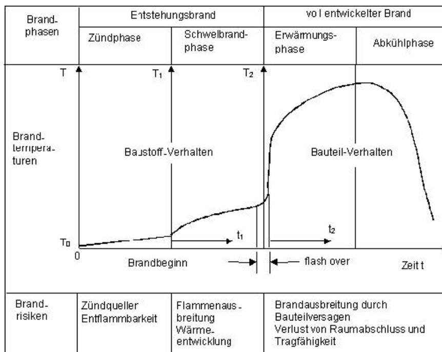
**Abbildung 1:** Einfluss von Baustoffen und Bauteilen auf das Brandverhalten
